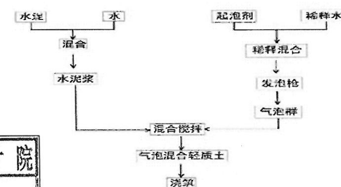
泡沫混凝土制作流程图
