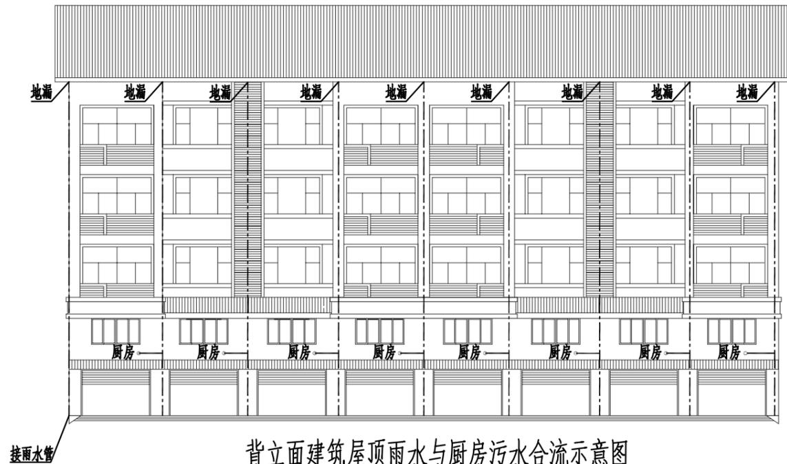
背立面建筑屋顶雨水与厨房污水合流示意图
