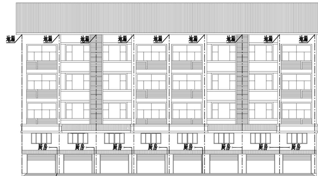
背立面建筑屋顶雨水与厨房污水合流示意图二
